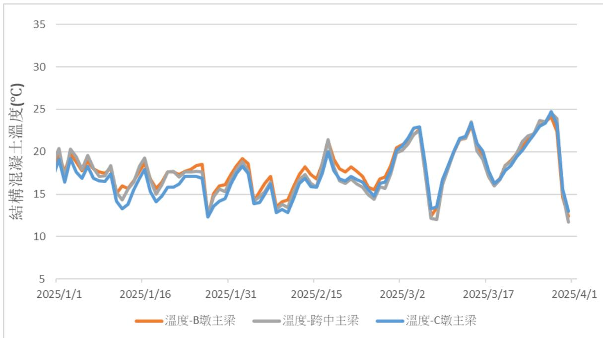
圖 9 本次監測期結構混凝土溫度 (°C) 變化圖
