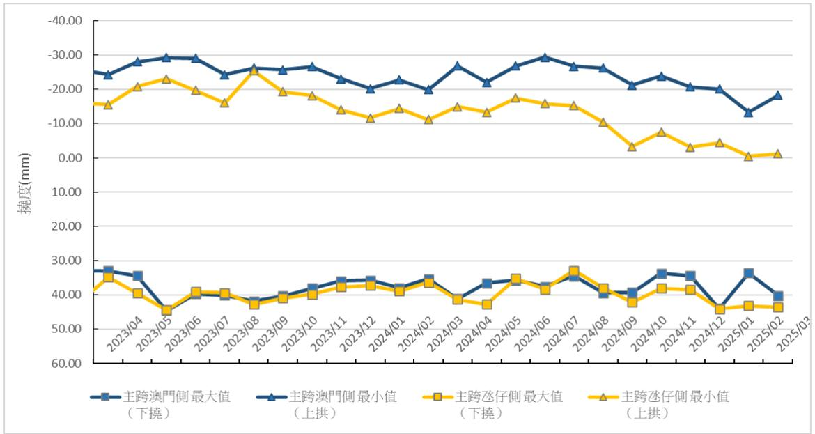
圖 4 主跨撓度最大值最小值逐月變化
