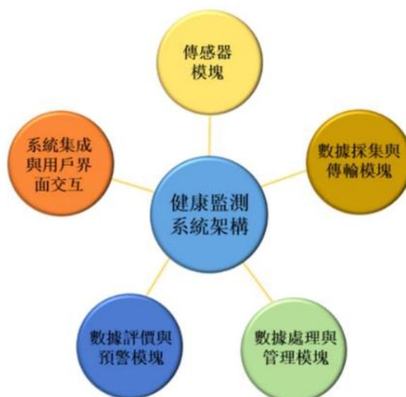
圖 1-3 橋梁健康監測系統架構示意圖
